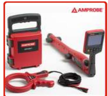
Detector de Cables Subterráneos Amprobe UAT-620
