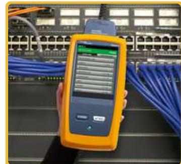
Certificador de cables de Cobre DSX2-8000 CableAnalyzer™
