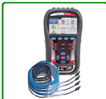
Analizador de Calidad de la Energía METREL 2892 con sensores AI502
