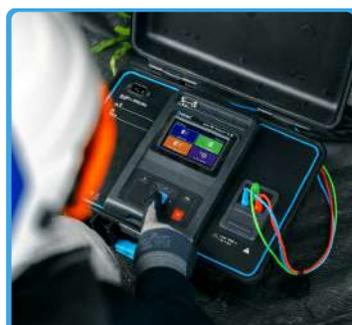
Medidor Fotovoltaico Trazador de Curva I/V METREL MI3116 PV
